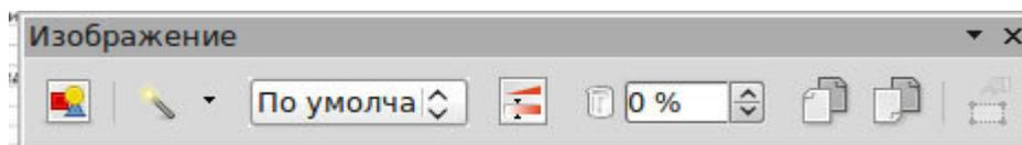
Для того чтобы открыть эту панель, нужно выполнить одну из команд: *Вид – Панели инструментов – Свойства рисунка* или *Сервис – Настройка – Панели инструментов – Свойства рисунка*.
