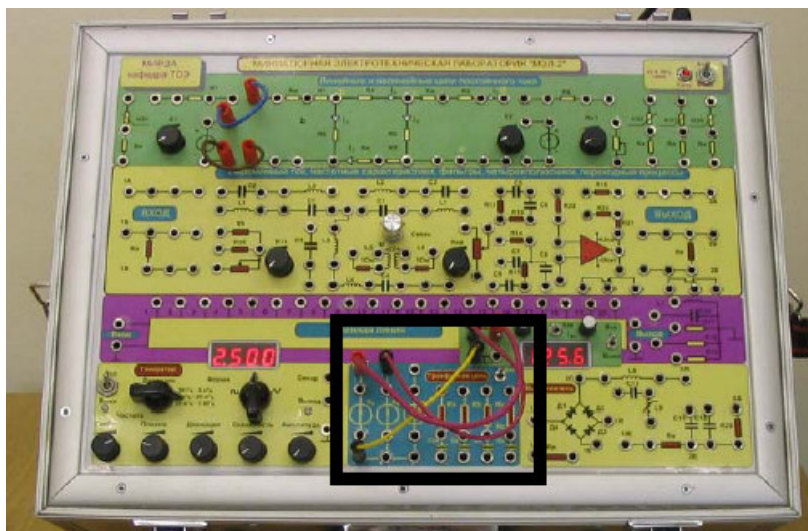
Рисунок 1. Панель МЭЛ для моделирования трехфазных электрических цепей
