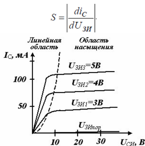
Рисунок 6. Выходные характеристики полевого транзистора КП902
