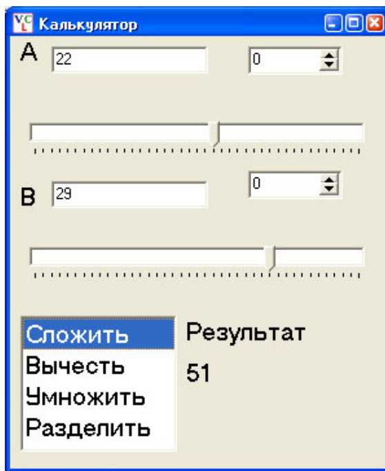
Рисунок 5. Использование элемента управления TrackBar
